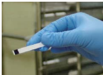
過酢酸液の有効濃度チェック試験紙 (アセサイドチェッカー；サラヤ)
