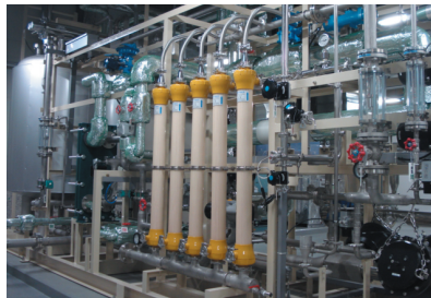
図4.14 UF水製造装置例 (NGKフィルテック株式会社 資料より)
